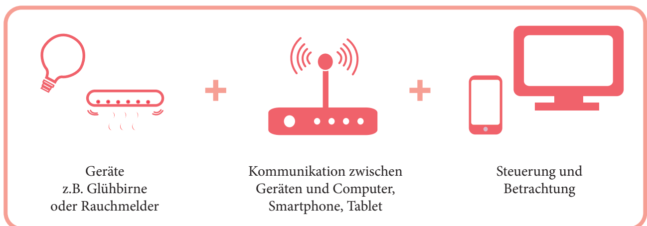
Schematische Darstellung der Funktionsweise von Smart Home; Abbildung: Caritas Stadtteilarbeit
